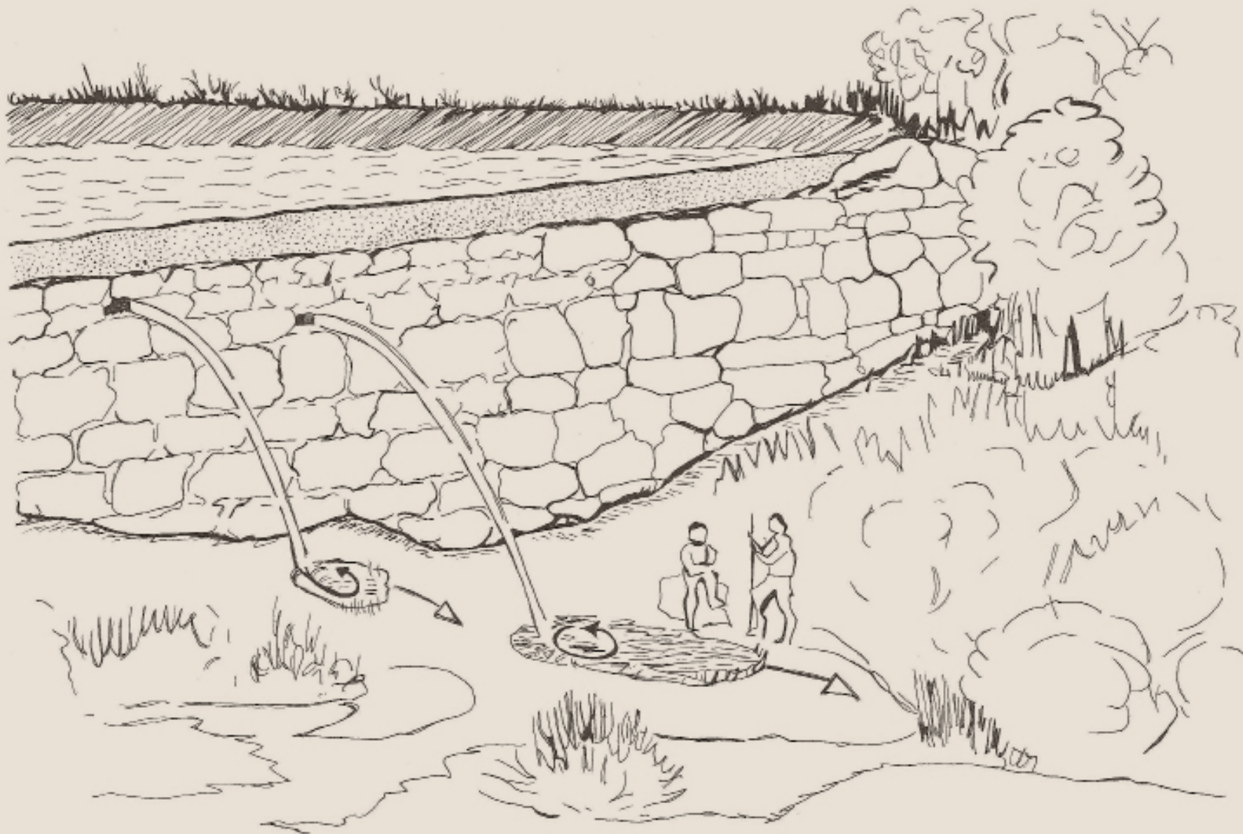
Fig. 3. Drawing representing the dam and artificial pond at Mycenae. (From Knauss J., Υστεροελλαδικά Υδραυλικά Έργα. Έρευνες για την Υποδομή Υδραυλικών Έργων Διαχείρισης Υδάτων κατά τη Μυκηναϊκή Περίοδο , Athens 2002, 66 fig.11. (Reproduction of drawing by N. Roumelioti).
